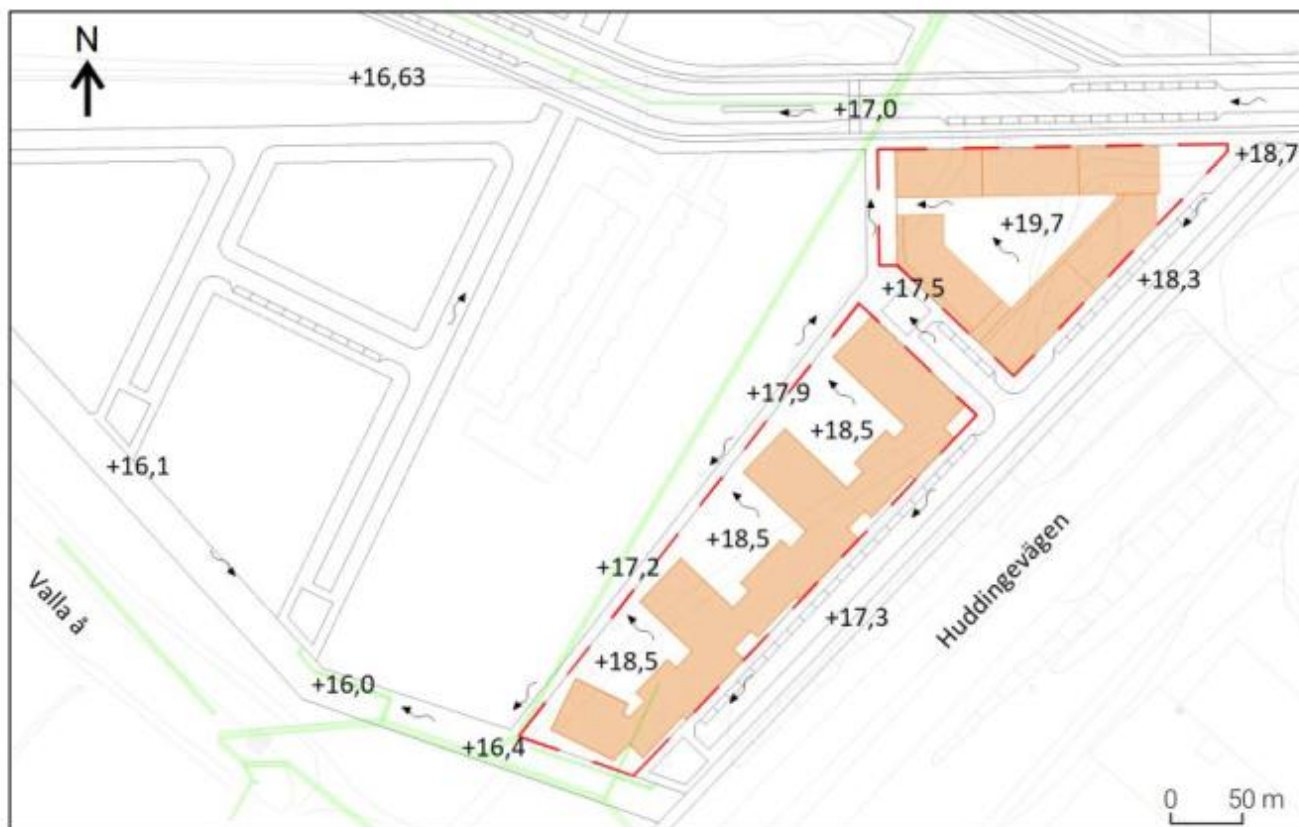
Figur 12.1. Framtida skyfallshantering. Plushöjderna är projekterade markhöjder och pilarna visar rinnriktning vid skyfallsflöden. Grön linje är projekterad dagvattenledning
