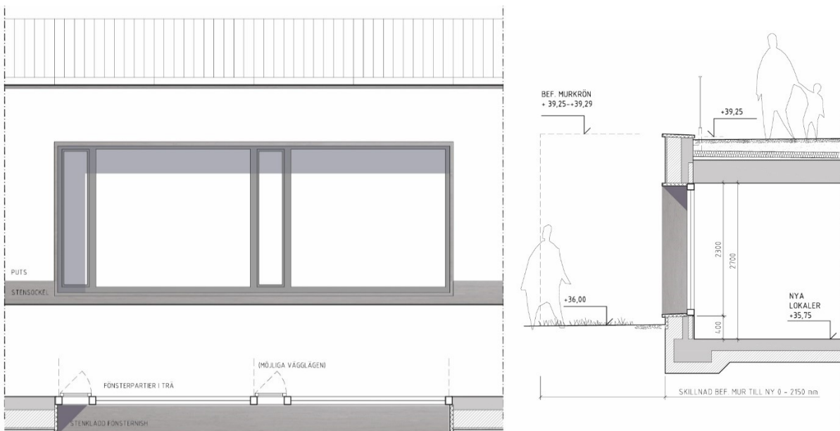
Figur 28. Inzoomning av murfasaden för den västra delen. Förslag till möjlig utformning. Bild: Erseus arkitekter.
