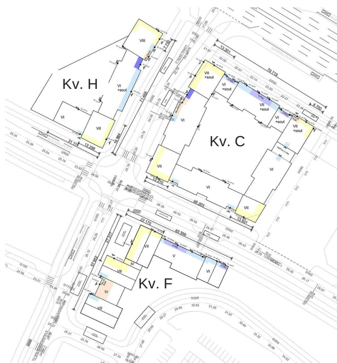
Figur 1. Planerad bebyggelse enligt utdrag från Situationsplan, förhandskopia daterad 2020-02-12. Kv. C utförs med 6 – 7 våningar över markplanet. Under huskroppen och innergården planeras källare- och gårdsunderbyggnad i suterräng. Lägsta golvnivå ligger på +22,2 – +24,0, motsvarande 0 – 2,4 m under angränsade gators planerade gatunivå. Kv. H utförs med 6 – 8 våningar. I västra delen av kvarteret samt under delar av huset planeras källare- och gårdsunderbyggnad i suterräng. Lägsta golvnivå ligger på +22,0 - +23,6, motsvarande 0 – 2,3 m under angränsade gators planerade gatunivå. Kv. F utförs med 4 - 7 våningar. Under gården i söder och delar av huset planeras källare- och gårdsunderbyggnad i suterräng. Lägsta golvnivå ligger på +26,6 - +27,6, motsvarande 0 – 4,0 m under angränsade gators planerade eller befintliga gatunivå.
