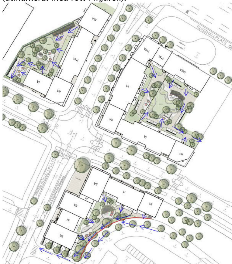
Figur 22. ByggVesta. Avrinningsvägar vid skyfall utmarkerat med blå pilar.
