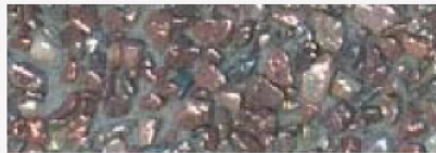
Betongelement med yta av frilagd ballast i småsten
