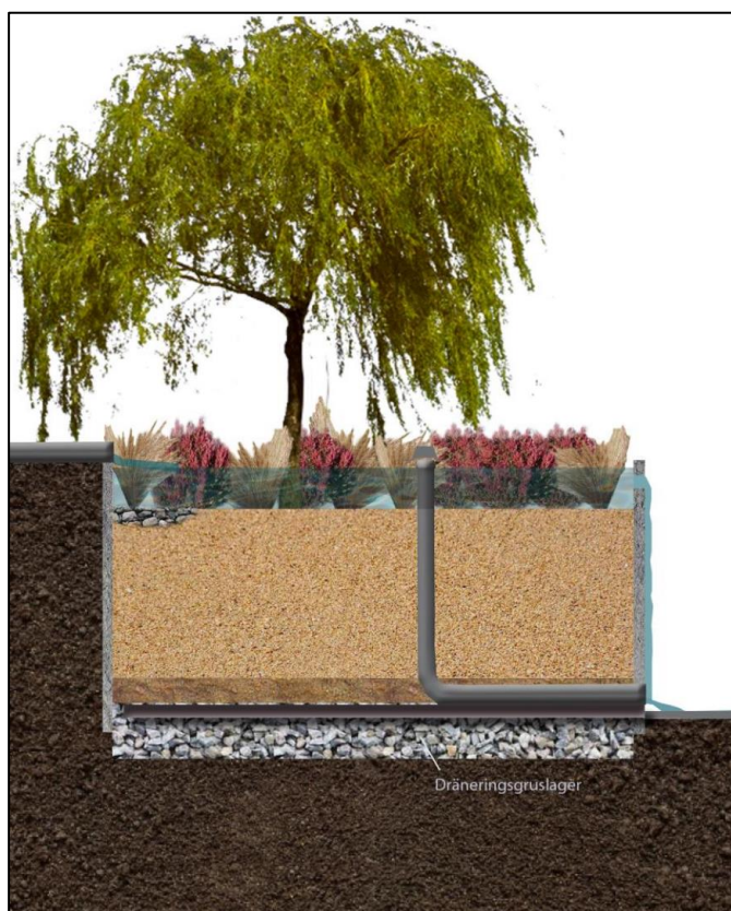
Figur 5-1. Exempelillustration av hur en regnbädd kan byggas upp (Illustration Åsa Wellander).
