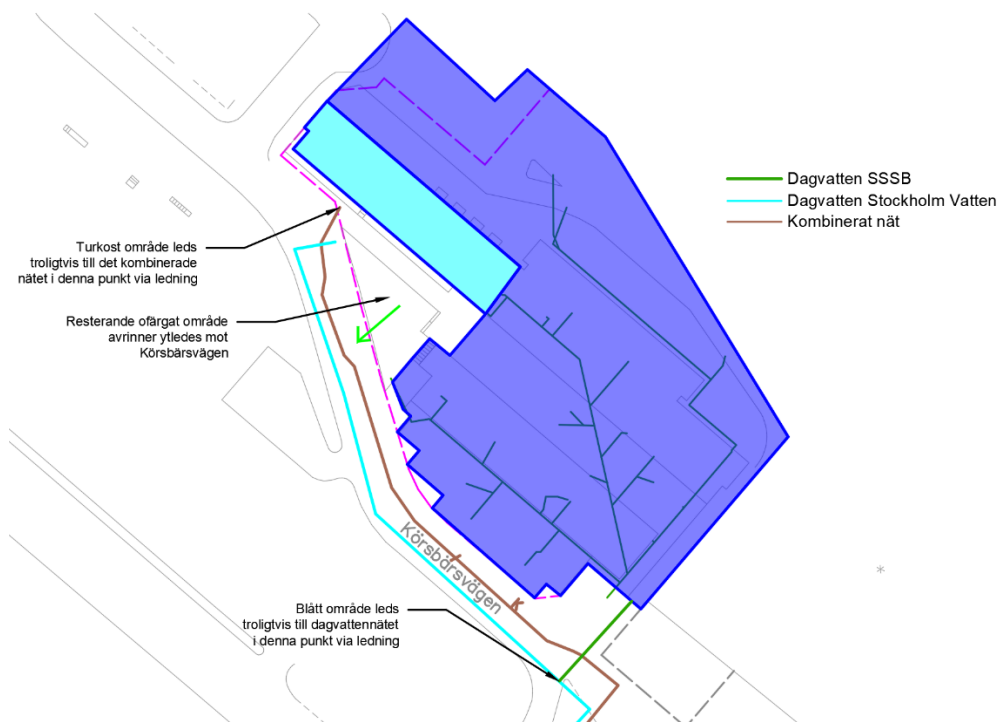
Figur 13 Illustration av avledning av dagvatten
