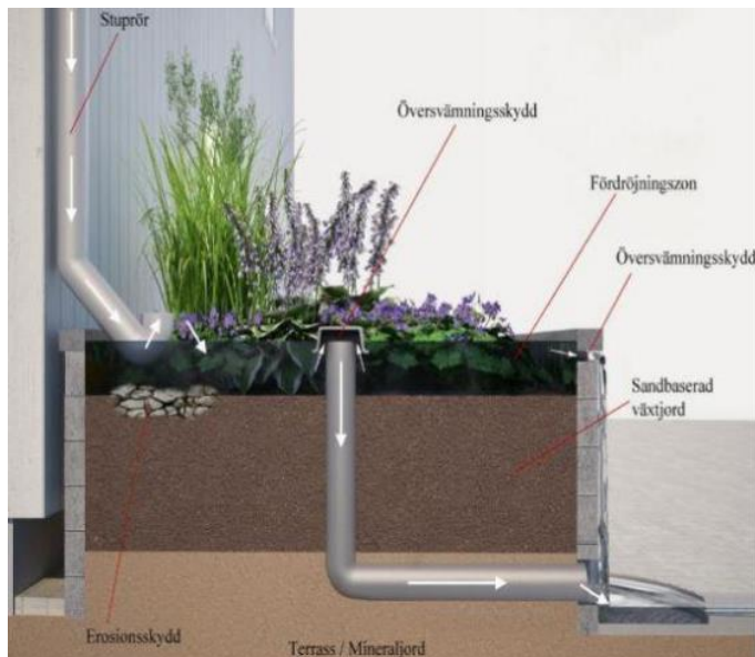
Figur 10. Principskiss över en växtbädd med stuprörsanslutning och bräddavlopp.
