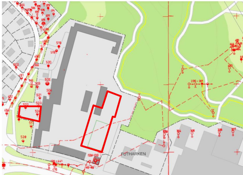
Figur 8: Geotekniska undersökningar i närområdet. Tillbyggnad och nybyggnad i rött. Notera att resultaten från dessa är inte tillgängliga elektroniskt i Stockholms stads Geoarkivet.
