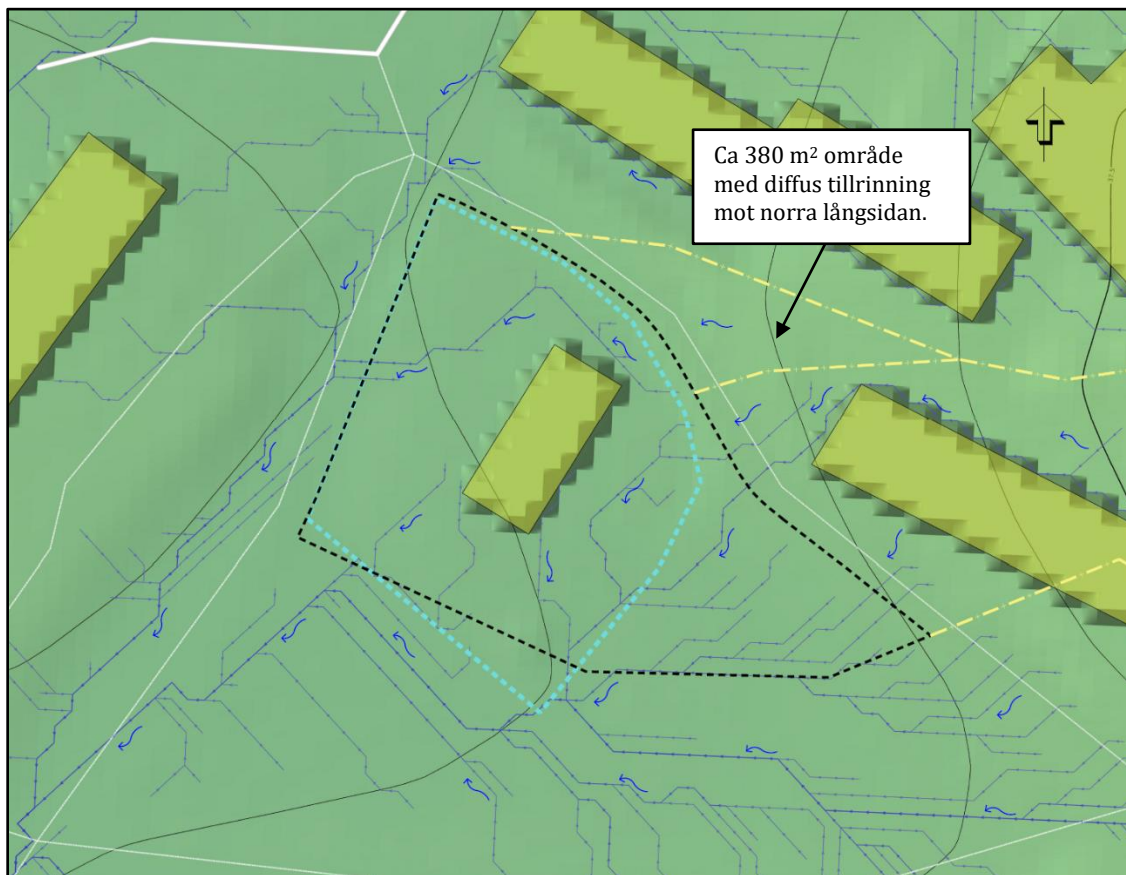
Figur 12. Översikt visande befintlig situation, med ytliga rinnvägar med riktningspilar (mörkblå linjer och pilar) modellerat i Scalgo Live (Marktema 2020). Cyan linje visar ungefärlig utbredning av befintlig fastighetsgräns. Svart linje visar ungefärlig utbredning av planerad fastighetsgräns. Gul linje visar del av utbredning av det tillrinningsområde som både före och efter planerad exploatering belastar planområdet.
