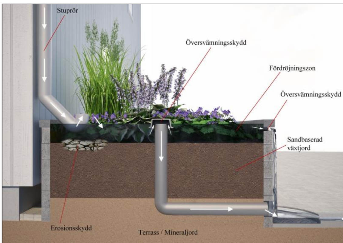
Figur 9-2. Exempel på utformning av en regnbädd, Tengbomgruppen AB, 2014.
