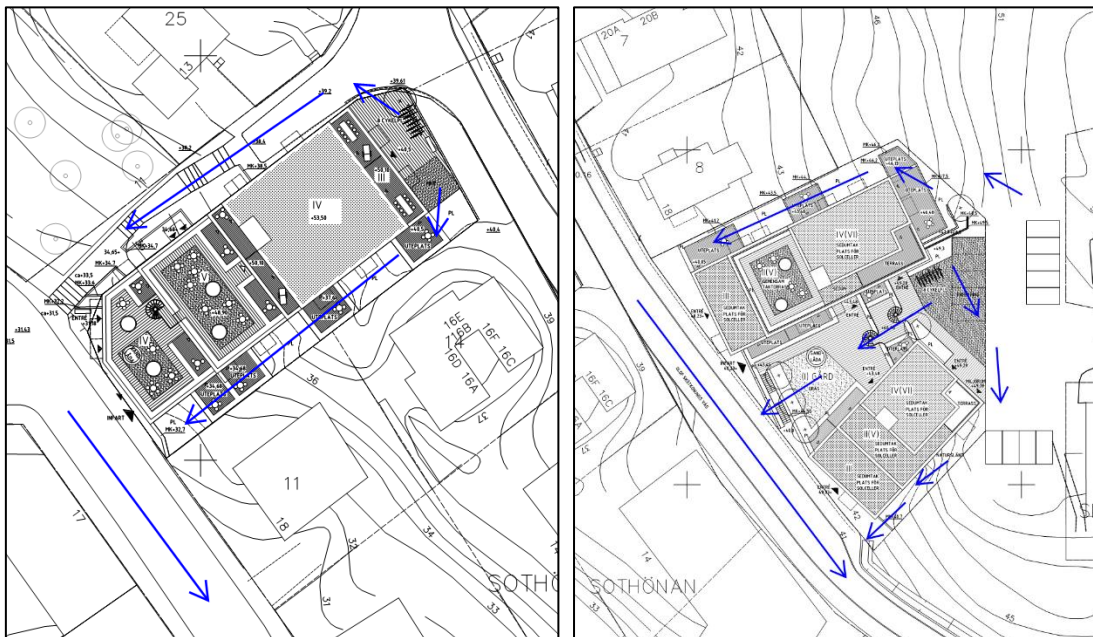
Figur 10-2. Principillustration med ytliga avrinningsvägar, illustrerade med blå pilar, inom Västra delen (t.v.) och Norra delen (t.h.) vid händelse av skyfall. De ytliga avrinningsvägarna behöver säkerställas genom höjdsättning av innergårdar och genomsläpplighet vid eventuella murar.
