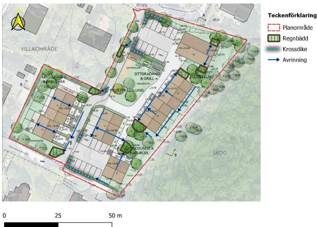
Figur 6-1. Översiktlig dagvattenlösning för planområdet.
