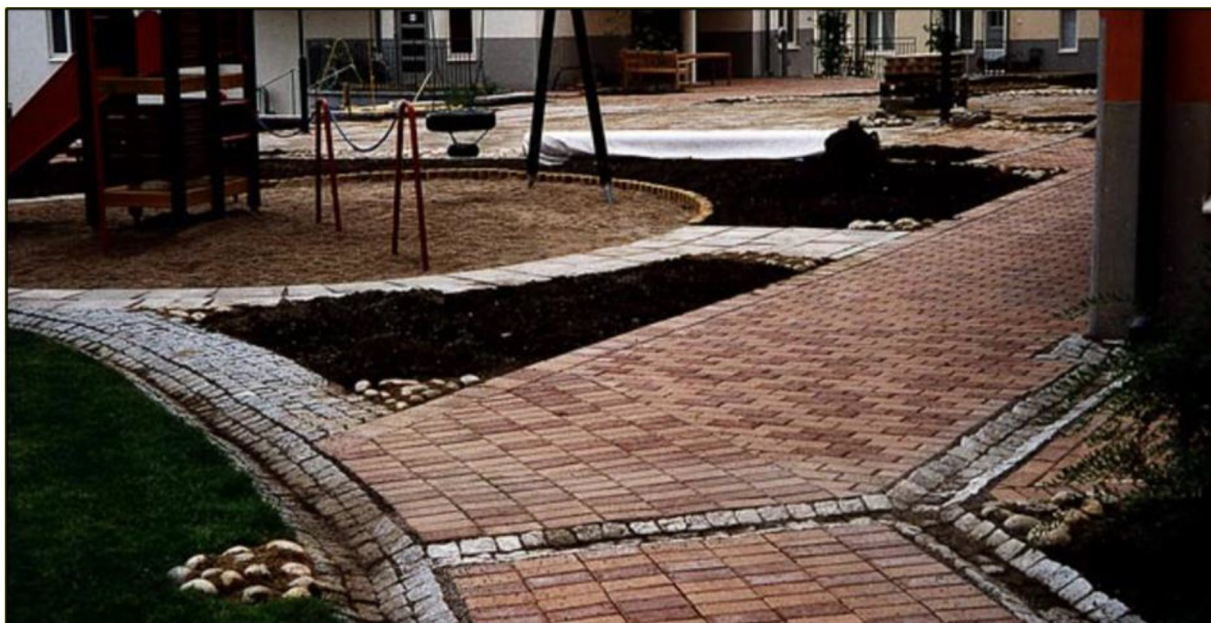
Figur 7-2. Exempel på avledning av takvatten via ränndalar anlagda med gatsten (Källa: Stockholm Vatten AB, n.d.).
