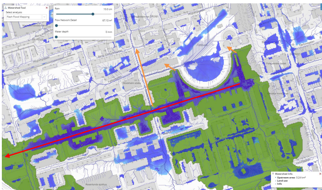
Figur 12b – Avrinningsområde vid skyfall (grön), översvämningssområde som fylls upp (blått) och sekundära rinnvägar samt trösklar med ytliga utlopp (orange) och ledningsnätutlopp (rött)
