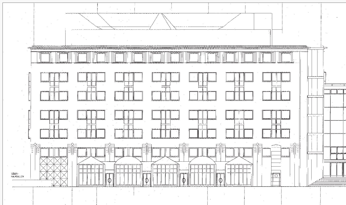
En jämförelse mellan en ritning av Björkshallshusets östa fasad, från bygglov 1989, och ett nytaget fotografi. Fasaden förenklades i ett sent skede vilket märks framförallt på fasadernas lisener och på utformningen av den översta våningen och takavslutet/gesimsen.
