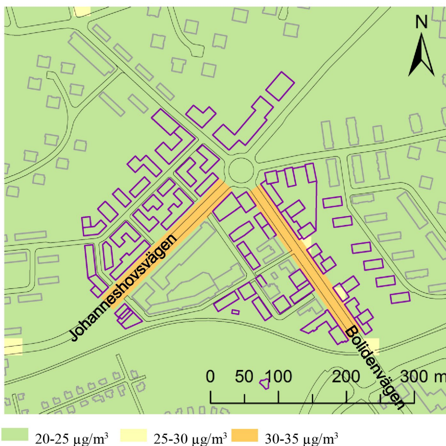
Figur 4. Beräknad dygnsmedelhalt av partiklar, PM10 ( \mu\text{g}/\text{m}^3 ) under det 36:e värsta dygnet för utbyggnadsalternativet år 2030. Normvärdet som ska klaras är 50 \mu\text{g}/\text{m}^3 . Planerade byggnader är inritade med lila konturer, befintliga med grå.
