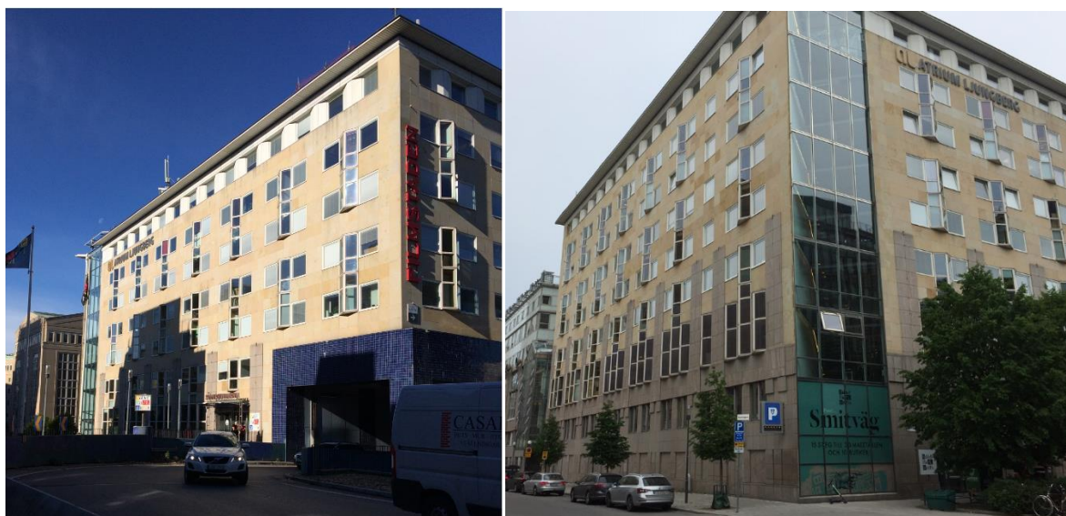
Björkhallens fasad: Fönstren veckas ut i ett litet burspråk som ger djupverkan och släppljus över fasaden. Takfoten är markerad, men bryts av vid de glasade partierna som ger ett diagonalt snitt genom byggnaden och som ger dagsljus in i ljushallen.
