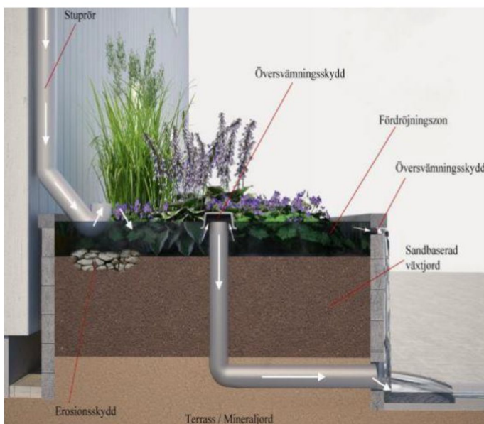
Figur 13. Principskiss över en växtbädd med stuprörsanslutning och bräddavlopp.
