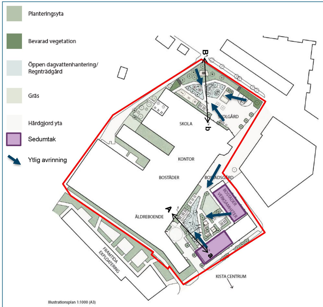
Figur 9-1 Förslag på dagvattenhantering med sedumtak och regnträdgårdar. Fastighetsgräns markerad med rött. Sektioner för de skisser som redovisas i Figur 9-2 och Figur 9-3 är utmärkta som A-a respektive B-b.
