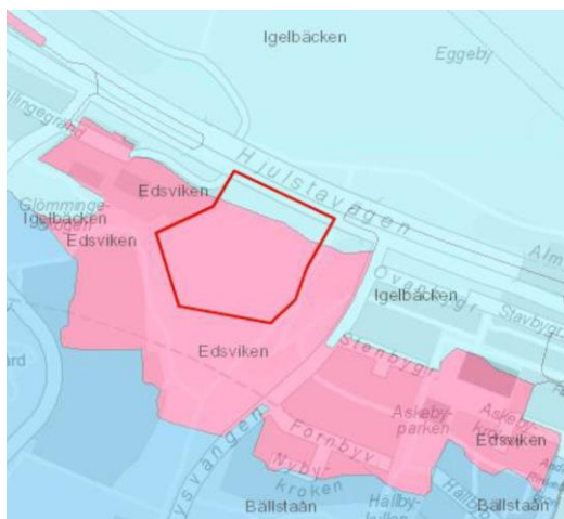
Figur 6 Tekniska avrinningsområden (Källa: Underlag för miljö- och hälsofrågor, 2020-08-17). Rosa område är Edsvikens tekniska avrinningsområde och ljusblått område är Igelbäckens tekniska avrinningsområde
