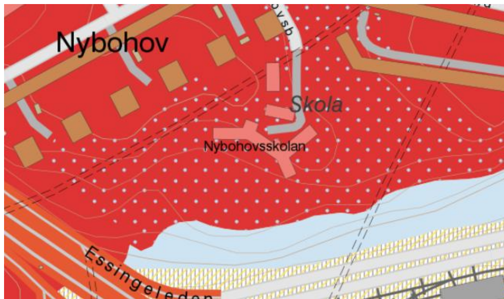
Figur 2: Jordartskarta hämtad från SGU:s hemsida. Rött=berg, Rött med ljusblå prickar= tunt eller osammanhängande ytlager av morän på berg, Ljusblått=morän, Skrafferat gult=fyllning på lera.
