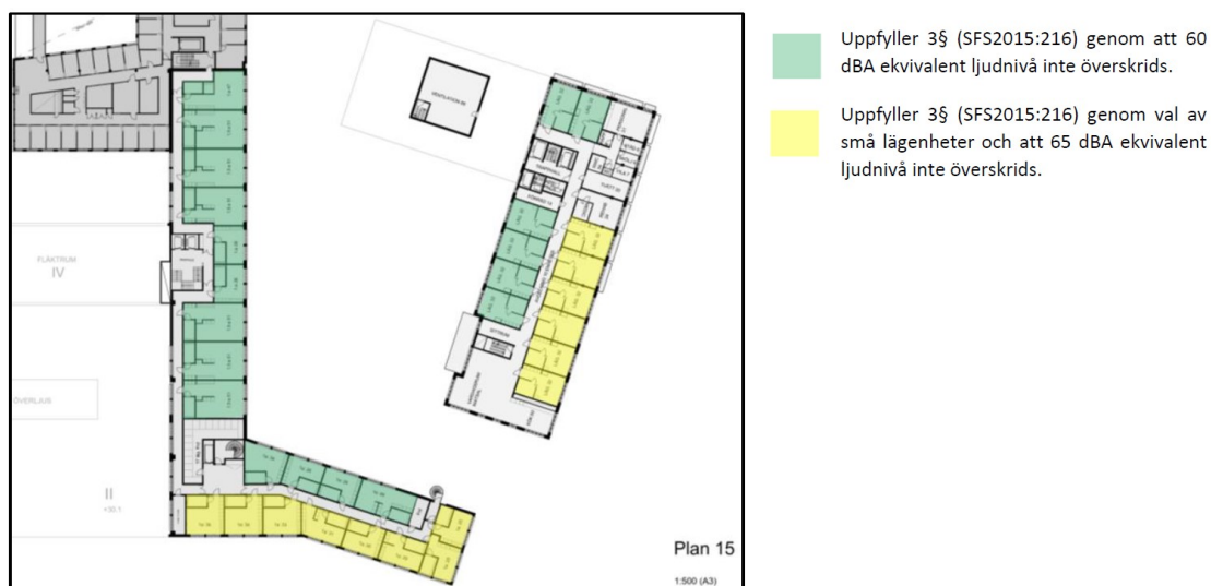
Illustrationen visar ett typplan och föreslagna lägenhetslösningar för att klara riktvärdena för trafikbuller.
