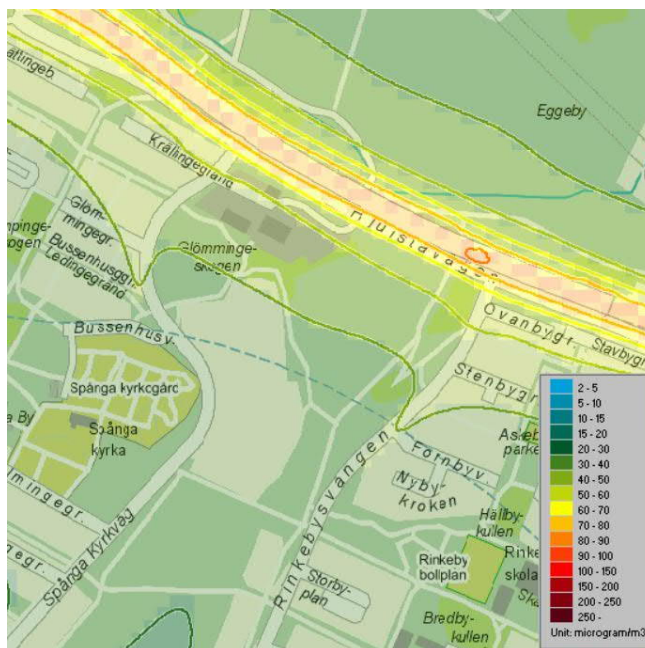
Figur 10 Beräknade dygnsvärden (98D) för NO 2 [ \mu\text{g}/\text{m}^3 ] i dagsläget. Miljökvalitetsnormen i omgivningsluft är 60 \mu\text{g}/\text{m}^3 och inget miljömål finns fastställt. Inom planområdet upplevs halter inom intervallet 35 - 59 \mu\text{g}/\text{m}^3 .
