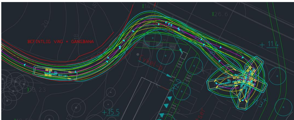
Figur 11: Körspår Boggibuss (Bb) - backvändning
