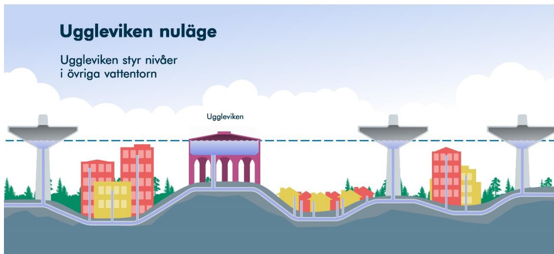
Figur 3. Förhållande mellan Uggleviken och övriga reservoarer i Stockholm i nuläget. Streckad linje visar bräddnivå i befintlig reservoar i Uggleviken.
