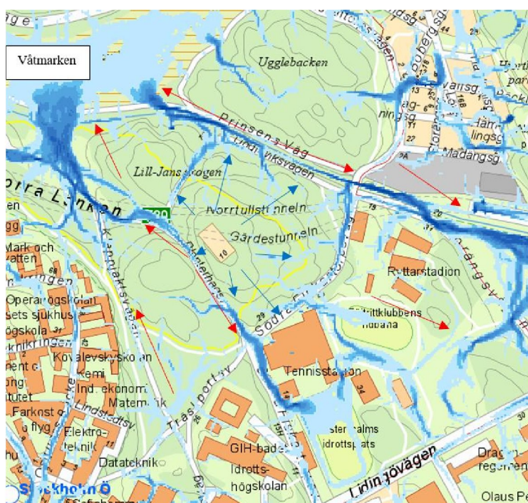
Figur 18. Stockholm Stads skyfallsmodell. Här ser vi den befintliga reservoaren som byggnaden med siffran 10 på, och att flödena går ner mot lågpunkterna. Ju mörkare blått desto större flödesvolym. Vattnets rinnvägar från befintlig reservoar är inritat med blå pilar. Röda pilar visar vattnets rinnvägar till recipient. Bildkälla: Dataportalen, Stockholm Vatten och Avfall
