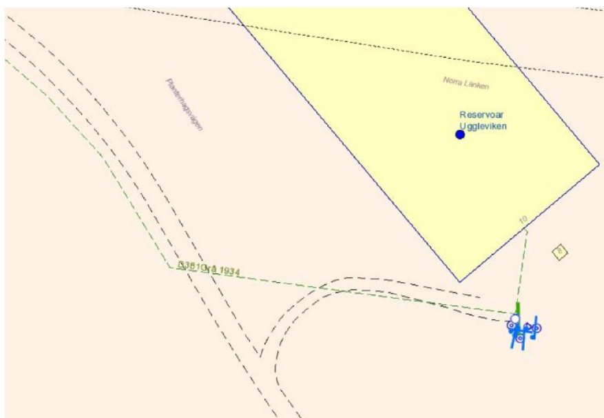
Figur 20. Befintligt dagvattennät till vattenreservoaren.
