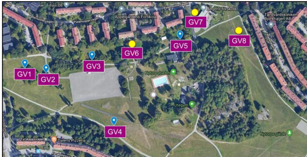
Figur 4. Placering av grundvattenrör. De med blåa etiketter (GV1, GV2, GV3, GV4 samt GV5) installerades i sep 2019 och de tre med gula etiketter (GV6, GV7, GV8) installerades i jan 2020.
