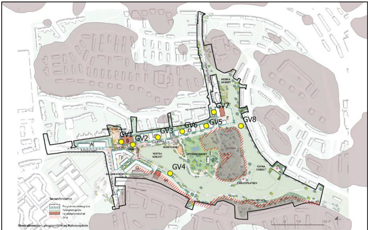
Figur 27. Programområdet (svart linje) i förhållande till grundvattenrör och "berg i dagen". Röd streckade områden beskriver zoner där grundvattenbildningen främst sker.
