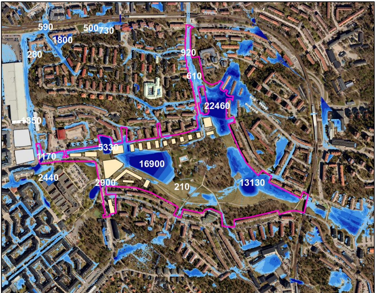
Figur 10. Maximala vattennivåer och utbredning av översvämning vid studerat 100-årsregn för planerad situation.
