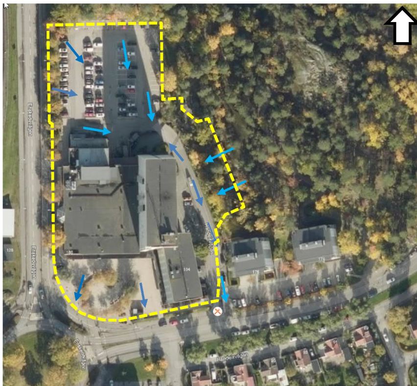
Figur 5. Ytlig avrinning inom utredningsområdet med befintlig bebyggelse (hitta.se), där blå pilar anger flödesriktningen. Den ytliga avrinningen bibehålls i stort efter omdaning, se avsnitt 8.3, 10 och 11.
