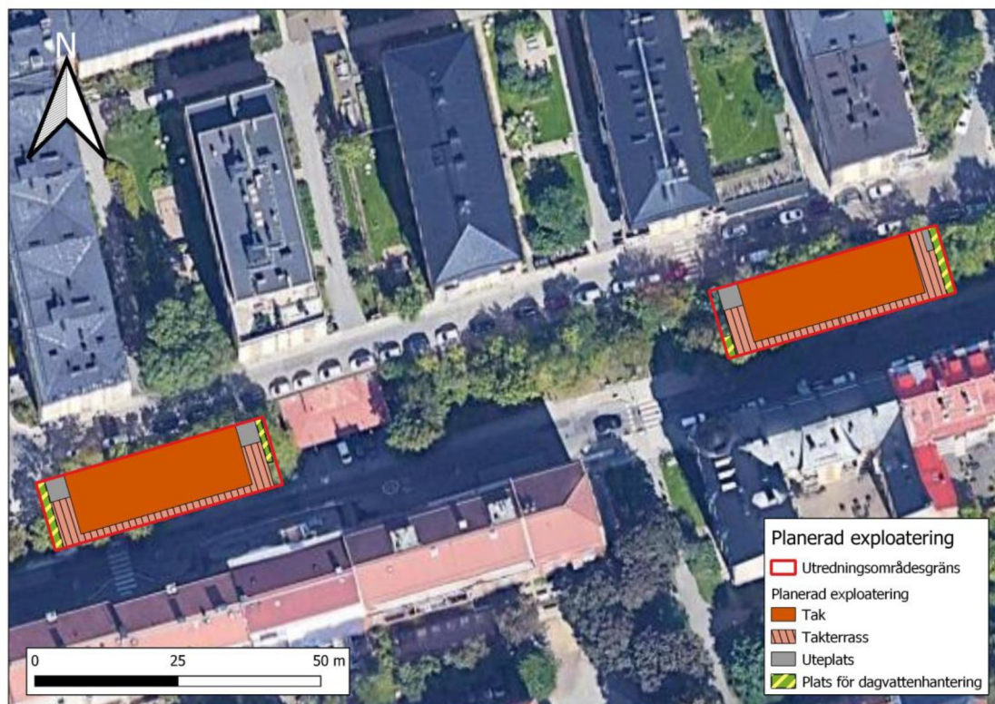
Figur 7. Planerad exploatering på Lundagatans slänt. De två husen har liknande utformning med tre våningar i suterräng och en fjärde, mindre våning högst upp. Inom utredningsområdesgränserna har fyra mindre ytor lämnats intill husens kortsidor för lokalt omhändertagande av dagvatten från husen. Källa ortofoto: Google maps, 2021.
