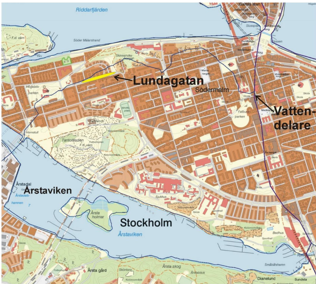
Figur 5. Ytavrinningsområde. OBS: det mesta dagvatten från området avrinner i kombinerat ledningsnät till Strömmen via Henriksdals reningsverk. Endast vid höga flöden kan ytvatten avrinna mot Årstaviken. Källa: VISS (2017-10-04)
