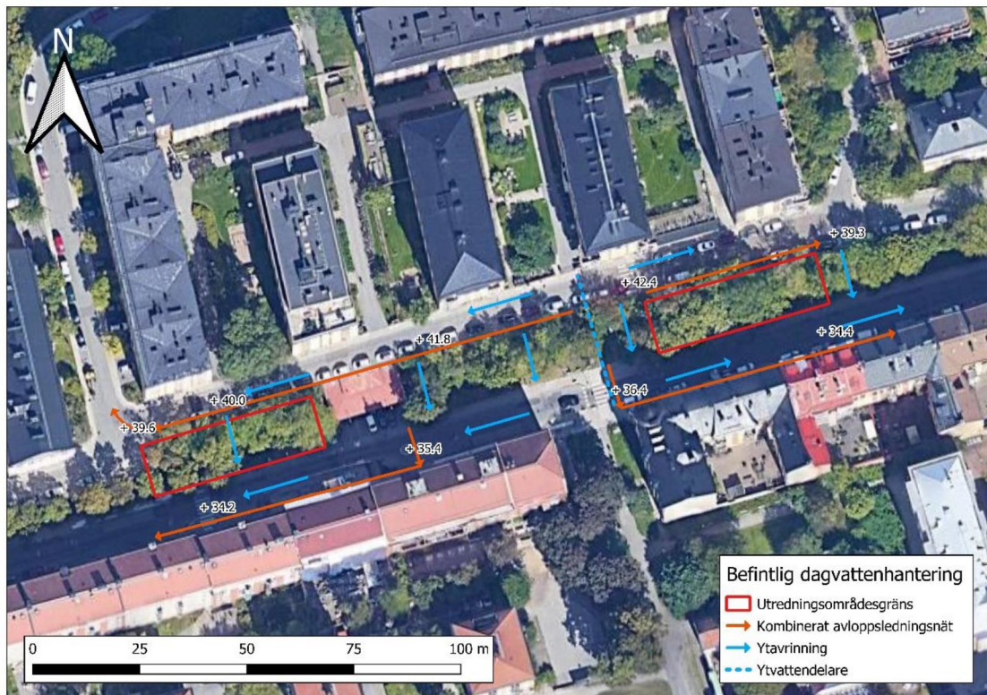
Figur 4. Befintlig dagvattenhantering i området. Området delas av en ytvattendelare som avleder ytvatten åt öster och väster. Detsamma gäller för ledningssystemet där dagvatten avleds i kombinerade avloppsledningar. Ledningarnas placering och höjdangivelser är inte exakta, för exakt placering se ledningskarta från Stockholm Stad. Källa ortofoto: Google maps, 2021.
