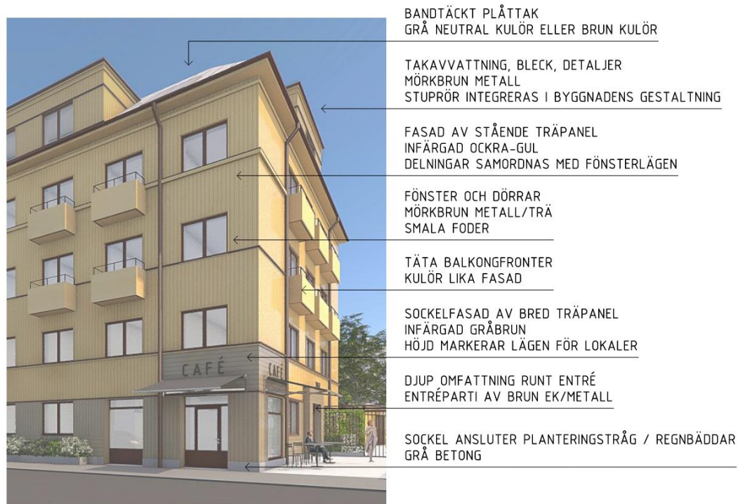
Norra delområdet. Material och förslag till kulör för byggnaden. Bild Robert Sandell Arkitektkontor.
