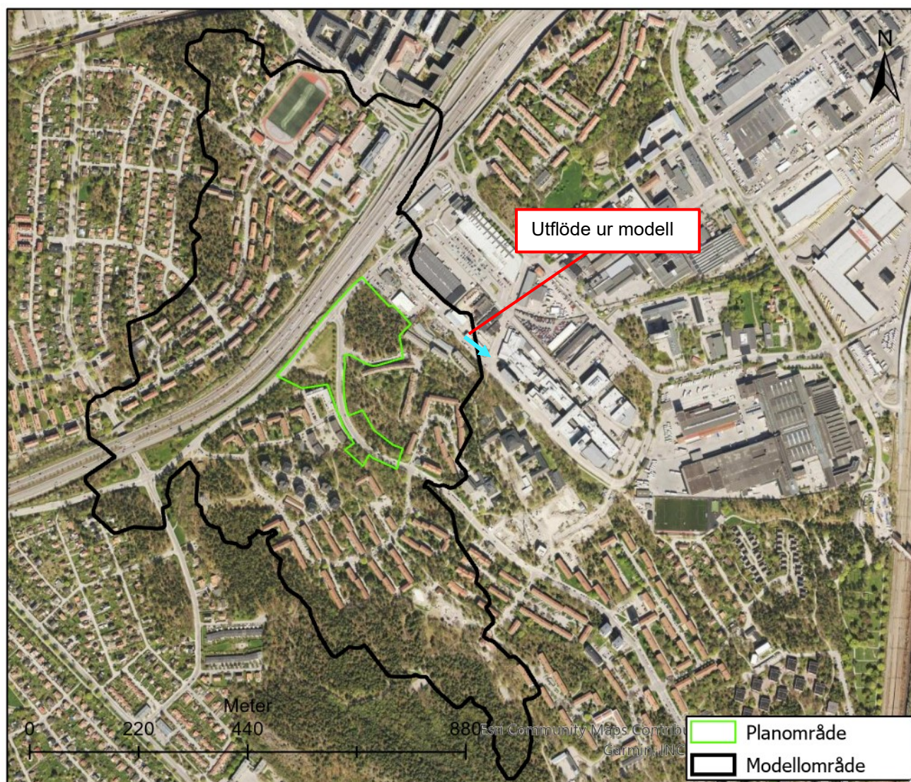
Figur 9. Modellområde för den hydrauliska modellen. Området motsvaras av avrinningsområdet till planområdet och de områden i anslutning till planområdet som kan påverkas av förändringar i planen och skyfallshanteringen där. Vatten flödar ut ur modellområdet längs Lerkrogsvägen
