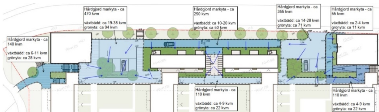
Dagvattenhantering i kvarteret Socialministern. Blå pilar visar antagen flödesriktning. (Bild: Tyréns)
