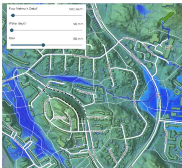
Resultat från Scalgo Live som visar rinnvägar och var vatten blir stående efter 68 mm regn.
