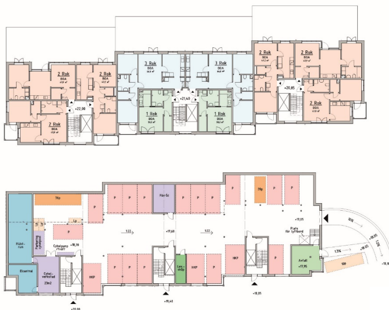
Illustration Hus 2, garageplan och plan 1 med uteplatser mot Långseleringen. Andersson Arwedsen arkitekter
