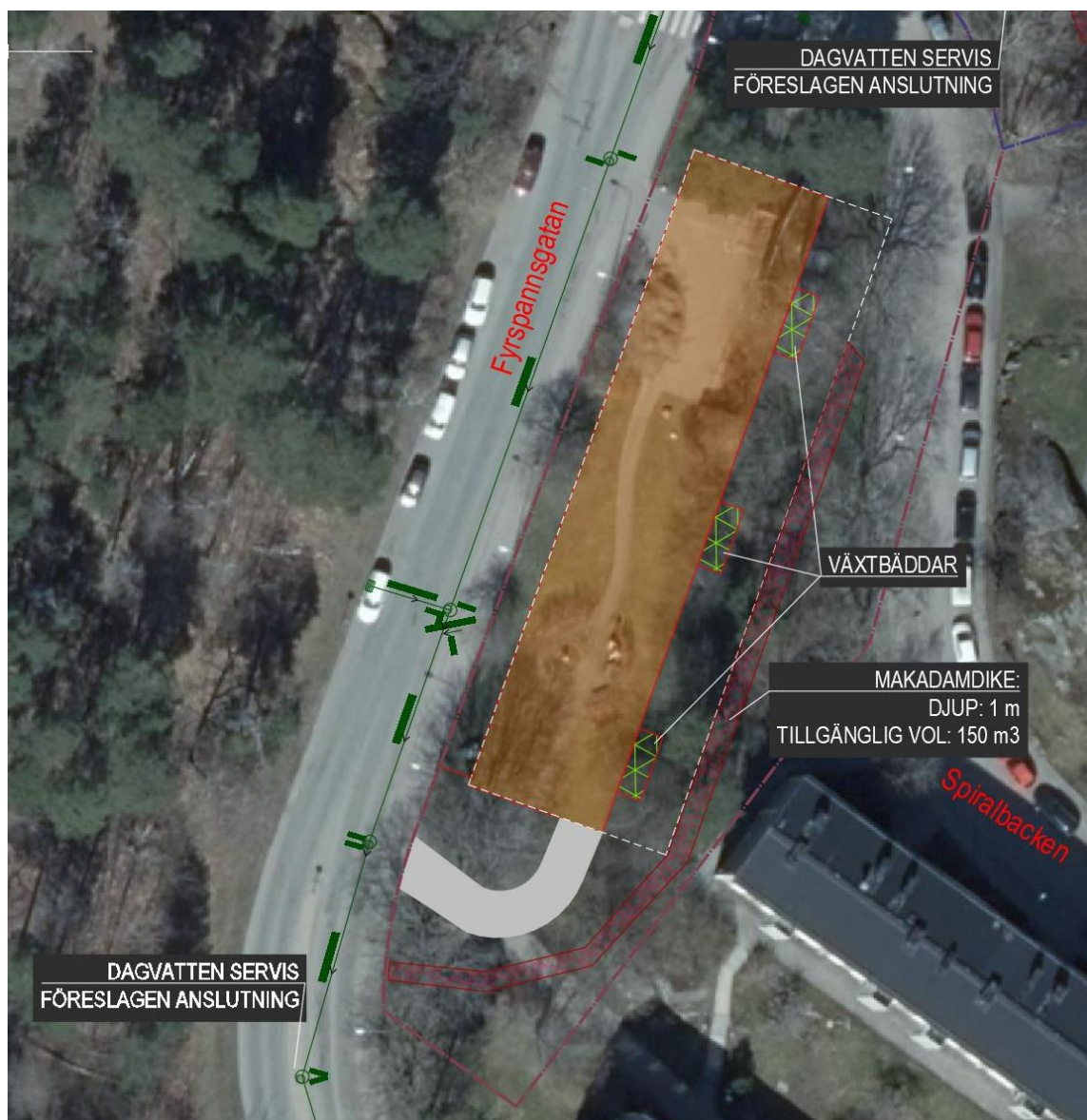
Figur 21. Principskiss över dagvattenhantering för delområde i söder.
