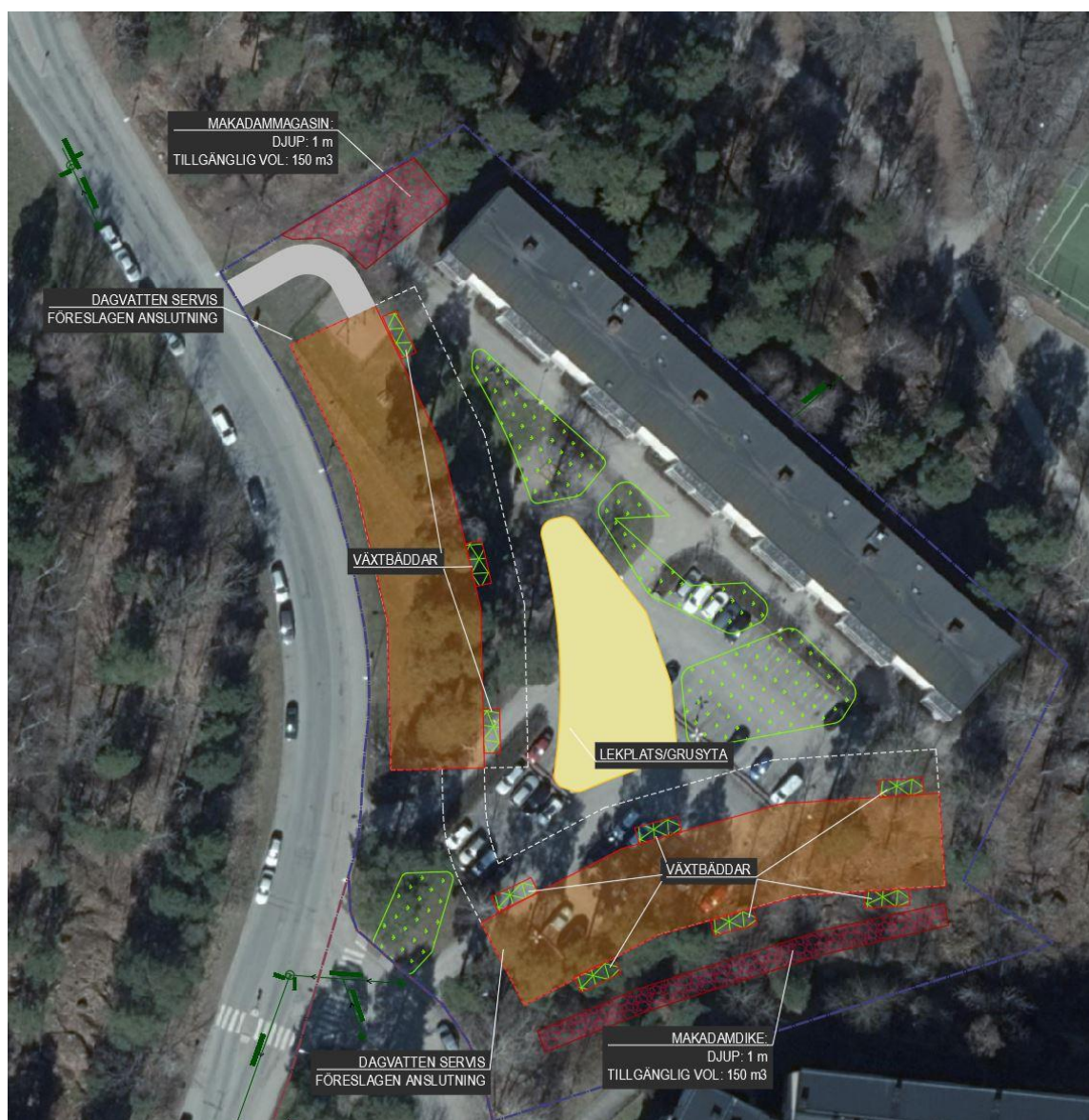
Figur 20. Principskiss över dagvattenhantering för delområde i norr.
