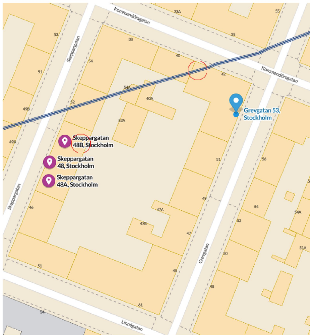
Figur 1) Mätpositioner för vibrationsmätning (röda cirklar), tunnelbanans sträckning diagonal under kvarteret (blått streck) samt adresser för orientering.
