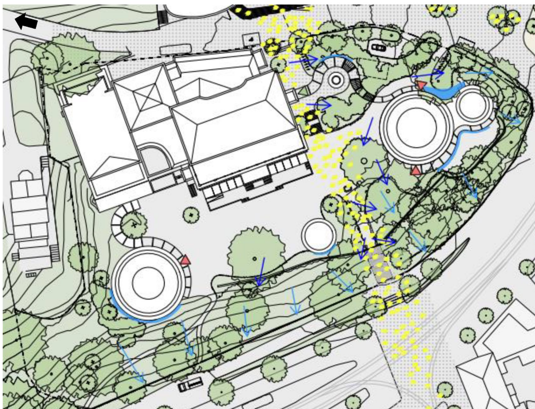
Figur 11. Avrinningsvägar baserat på höjsättning inom området utmarkerat med ljusblå bilar. Mörkblå pilar är förslag på avledning av vatten från antagna hårdgjorda markytor. Utmarkerade blå områden visar förslag på placering av stenkistor, de redovisar inte den yta som behövs utan endast förslag på placering. Som grund till figur ligger underlag erhållet från arkitekt (Lundgaard & Tranberg Arkitekter, 2022-02-25).
