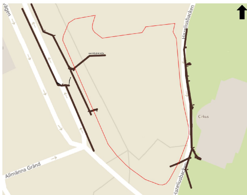
Figur 6. Urklipp av kombinerade ledningsnätet från samlingskarta (markerat med bruna linjer) med utredningsområdet markerat med röd linje. Bräddledning mot Strömmen ej med i karta.
