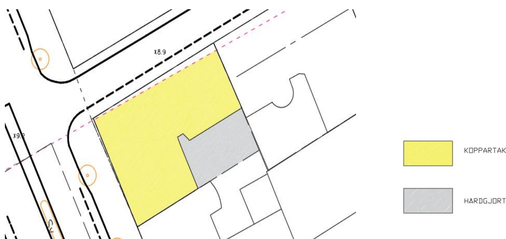
Figur 7. Ytor före påbyggnad.
