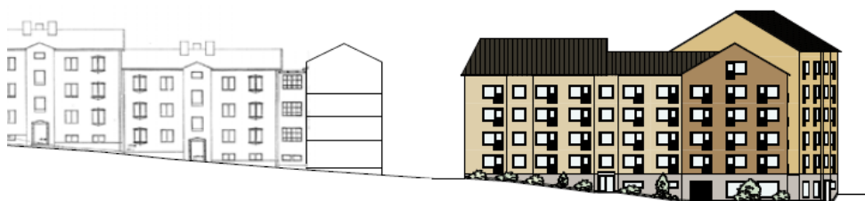
Den nya fasaden knyter an till 1950-talets gatufasad längsmed Wergelandsgatan med förskjutningar i fasadliv (Liljewall arkitekter).
