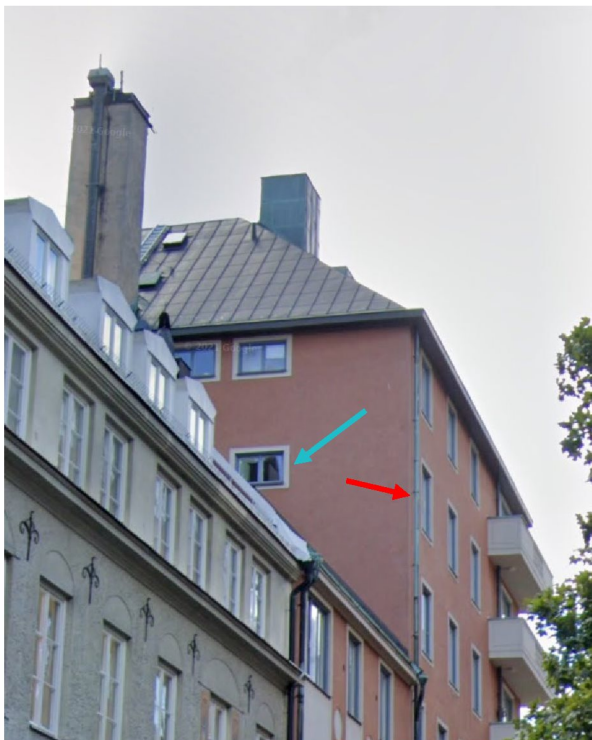
Figur 2. Sovrum på plan 6 med fönster mot "tyst sida" (turkos pil) och bullerutsatt sida (röd pil).
