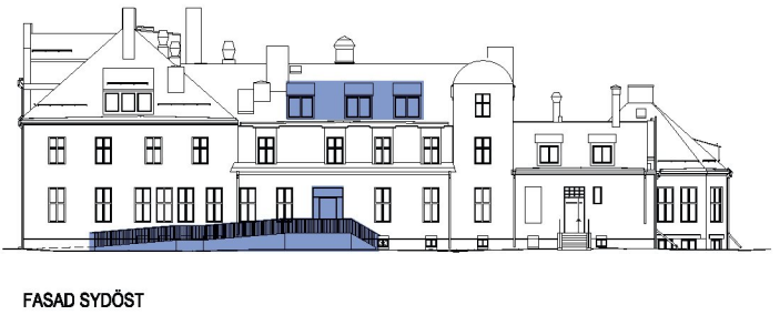
Relationsritningar samt förslag. Ändringar är markerade med blått.
