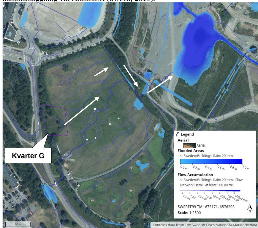
Figur 5. Avrinning inom etapp 5 sker idag mot ost/nordost mot befintlig damm (Valla damm). Blåa linjer visar avrinningsvägar vid 20 mm nederbörd och vita pilar visar rinnriktningen. Bild från SCALGO Live och höjder baseras på Lantmäteriets höjddata.
