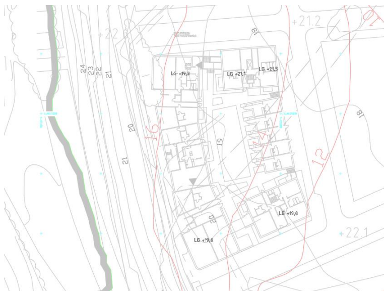
Figur 3. Bedömda jordlagerförhållanden inom kvarter H. Grå linje visar gräns mellan fastjord och lera, röda linjer visar bergnivåer och grå moln visar berg i dagen eller på litet djup till berg.
