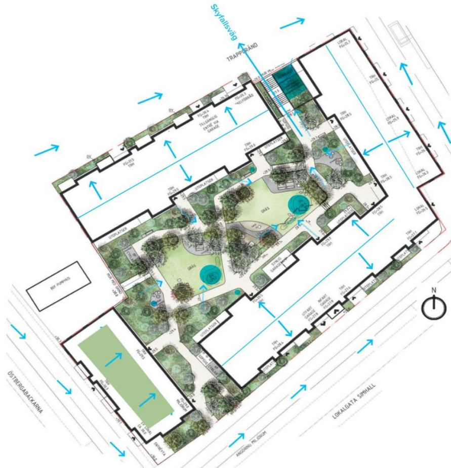
Figur 14. Kvarter J med skyfallsvägar markerade med blåfärgade pilar
