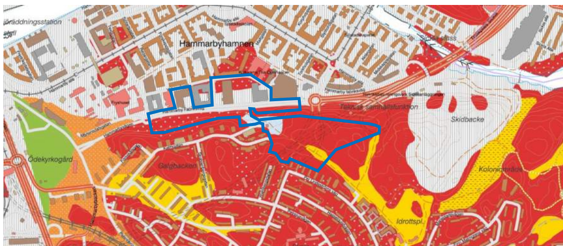
Figur 5. Jordarter i området runt Hammarbybacken. Blå markering är ungefärligt planområdet för Sjöstadshöjden. Röd färg illustrerar områden med ytnära berg, blå färg - morän, gul färg - lera.
