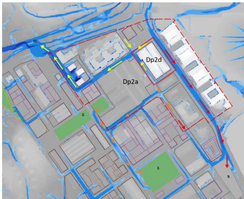
Figur 12 Beräknade flöden inom och från Dp2a, röd heldragen linje är plangränsen för Dp2d, röd streckad linje plangränsen för Dp2a, blåa fält visar beräknade flödesstråk och gula pilar huvudflödesstråk 1 västerut längs Stora Skorstensgatan vidare längs Hallvägen till befintligt spårområde nr: 12, och orangea pilar visar huvudflödesstråk 2 västerut längs Styckmästargatan till Hallvägen och norrut till västra och östra Fållan samt söderut till Centrala parken, och röda pilar huvudflödesstråk 3 söderut längs Arenavägen samt Rökerigatan till Evenemangstorget nr: 9 inom Dp4a.
