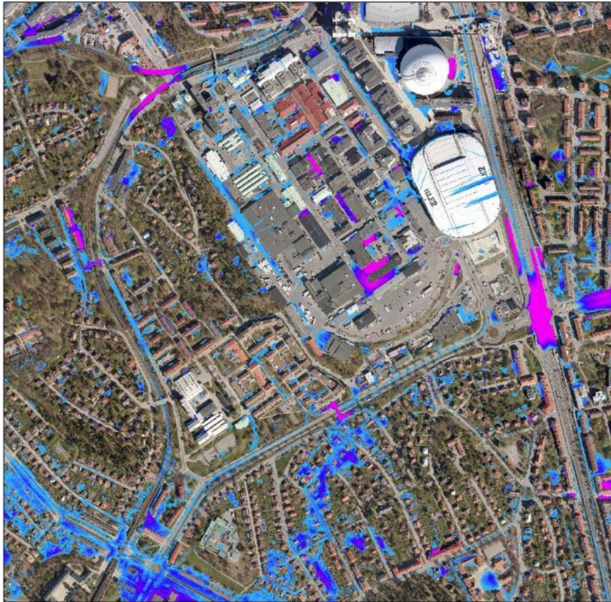
Figur 6 Nulägesmodellering, beräknat maximalt vattendjup vid ett klimatkorrigerat 100-årsregn.
