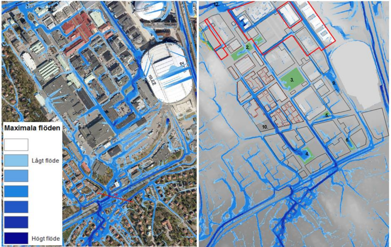
Figur 31 Beräknade flöde vid ett 100-årsregn, till vänster vid befintligt scenario och till höger vid ny exploatering.
