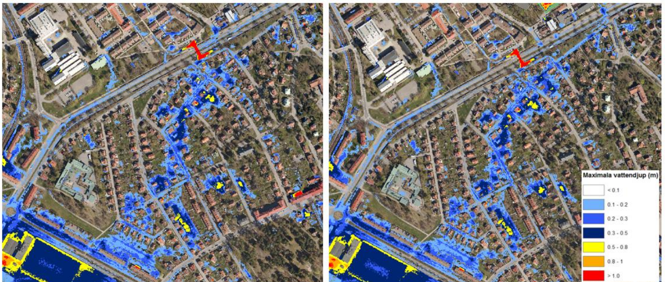
Figur 32 Beräknade maximala vattendjup i, till vänster vid befintligt scenario och till höger vid ny exploatering
