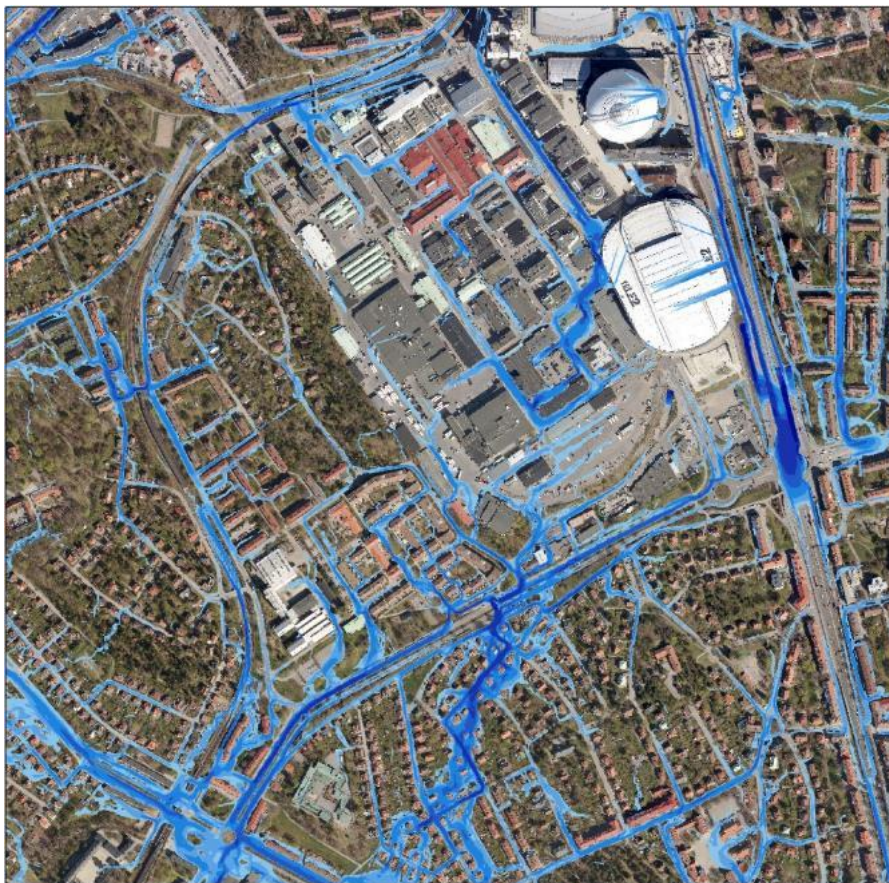
Figur 7 Nulägesmodellering, beräknade maximala flöden (m 3 /s/m) under hela simuleringen vid ett klimatkorrigerat 100-årsregn.
