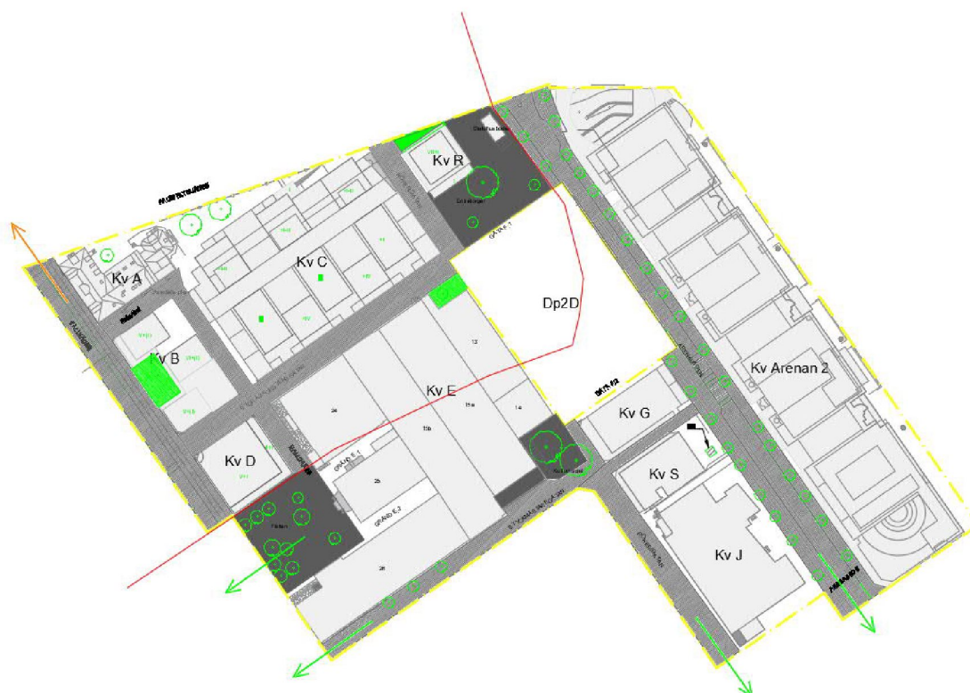
Figur 24. De två tekniska avrinningsområdena och utflödena från planen till Henriksdals avloppsreningsverk i Hallvägen (orange pil) och från Fällan, Styckmästaregatan, Rökerigatan och Arenavägen till Östberga dagvattentunnel nere vid Enskedevägen.
