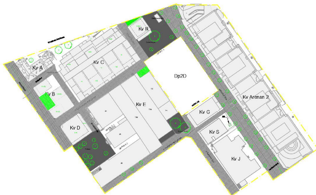
Figur 9. Framtida markanvändning. Grå skrafferade ytor är asfalterade vägar, ifyllda i mörkgrå är torg, gröna är park och ljusgrå är byggnader på kvartersmark. Vit är oklara ytor på kvartersmark men blir mestadels plattsatta ytor och grönytor.
