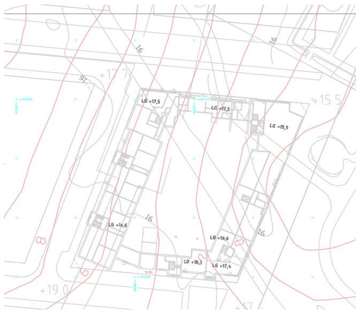
Figur 3. Bedömda jordlagerförhållanden inom kvarter A. Röda linjer visar tolkade bergnivåkurvor.
