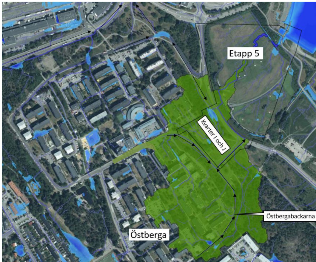
Figur 7. Planområdets tillrinningsområde enligt SCALGO LIVE. Grönt område motsvarar tillrinningsområdets utbredning, svarta pilar visar vattnets avrinningsriktning vid skyfall.
