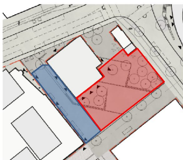
Undermarksutrymmen vid kv R, ungefärlig avgränsning. Blå yta är serverrum, röd yta är skyddsrum.
