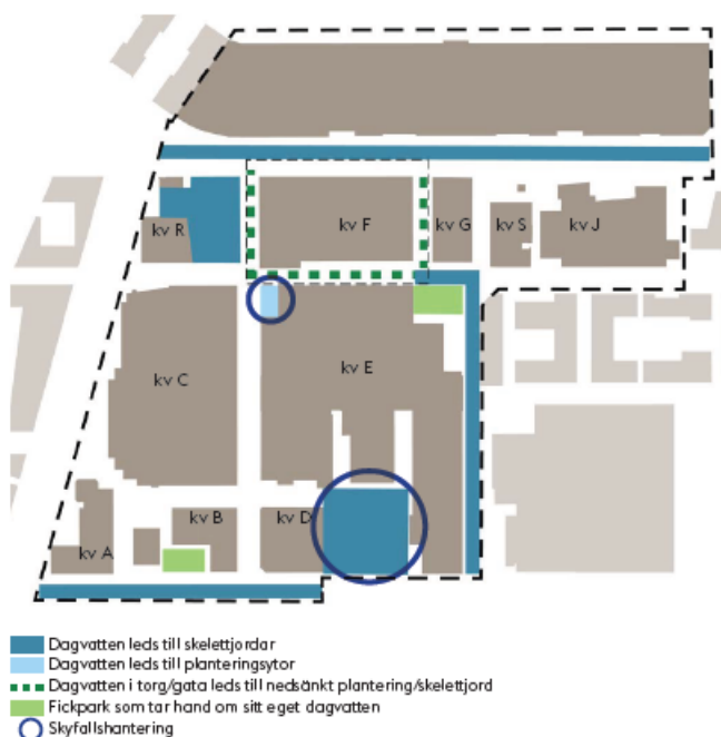
Illustration över planerad dagvattenhantering på allmän plats. Nyréns (gestaltnings-PM, allmän plats)
